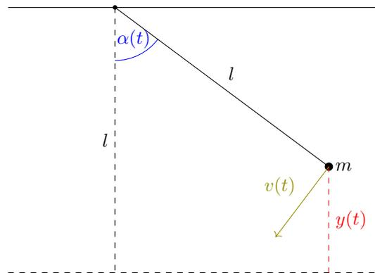
Zum Zeitpunkt  $t$  ist die Auslenkung der Masse durch den Winkel  $\alpha(t)$  gegeben. Nach dem Energieerhaltungssatz ist die Gesamtenergie des System  $E = E_{kin}(t) + E_{pot}(t)$  stets konstant. Hierbei bezeichnet
